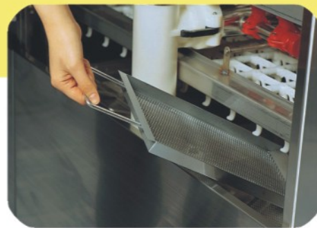
第一道水箱过滤器和第二道吸口过滤器 的组合保证洗涤水的清洁，也防止外来 物质流入水泵。所以这两个过滤器确保 水泵在任何时间正常运转。
